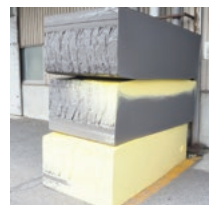
真ん中のブロックが色切り替え時の境目のウレタンフォーム
